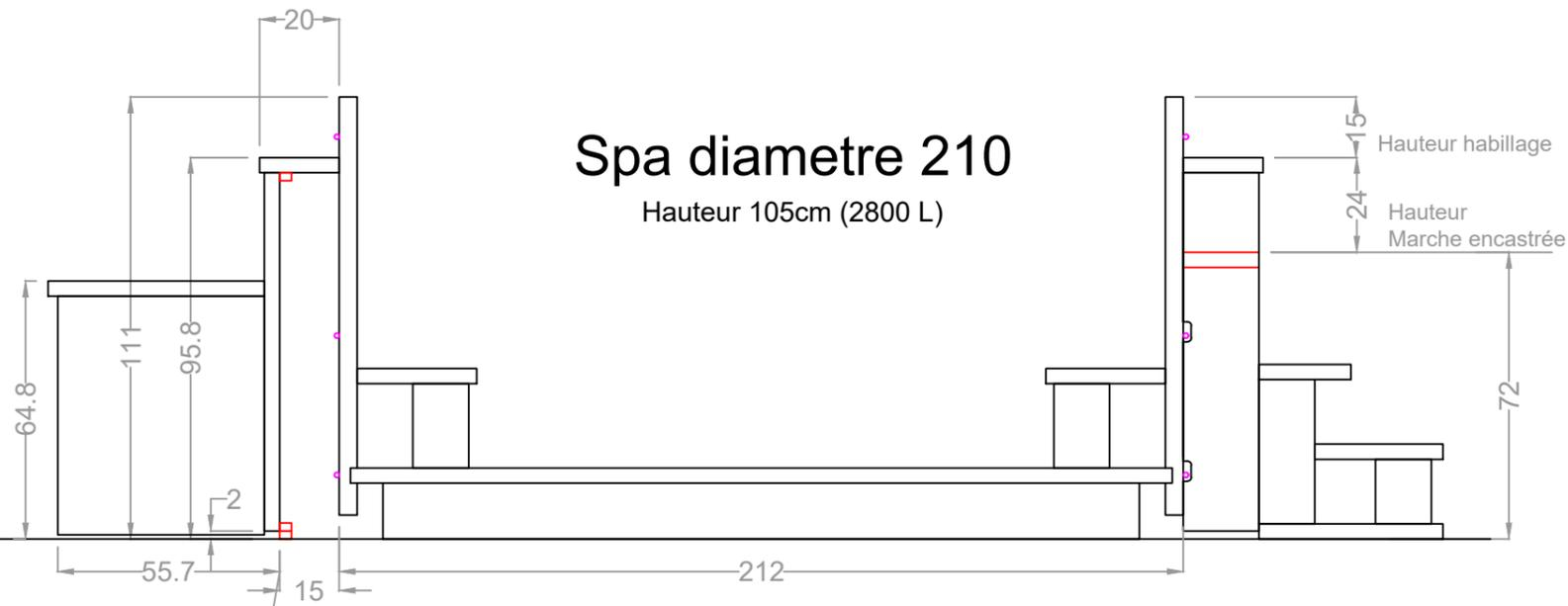
L'habillage doit impérativement reposer sur le plancher fini.
