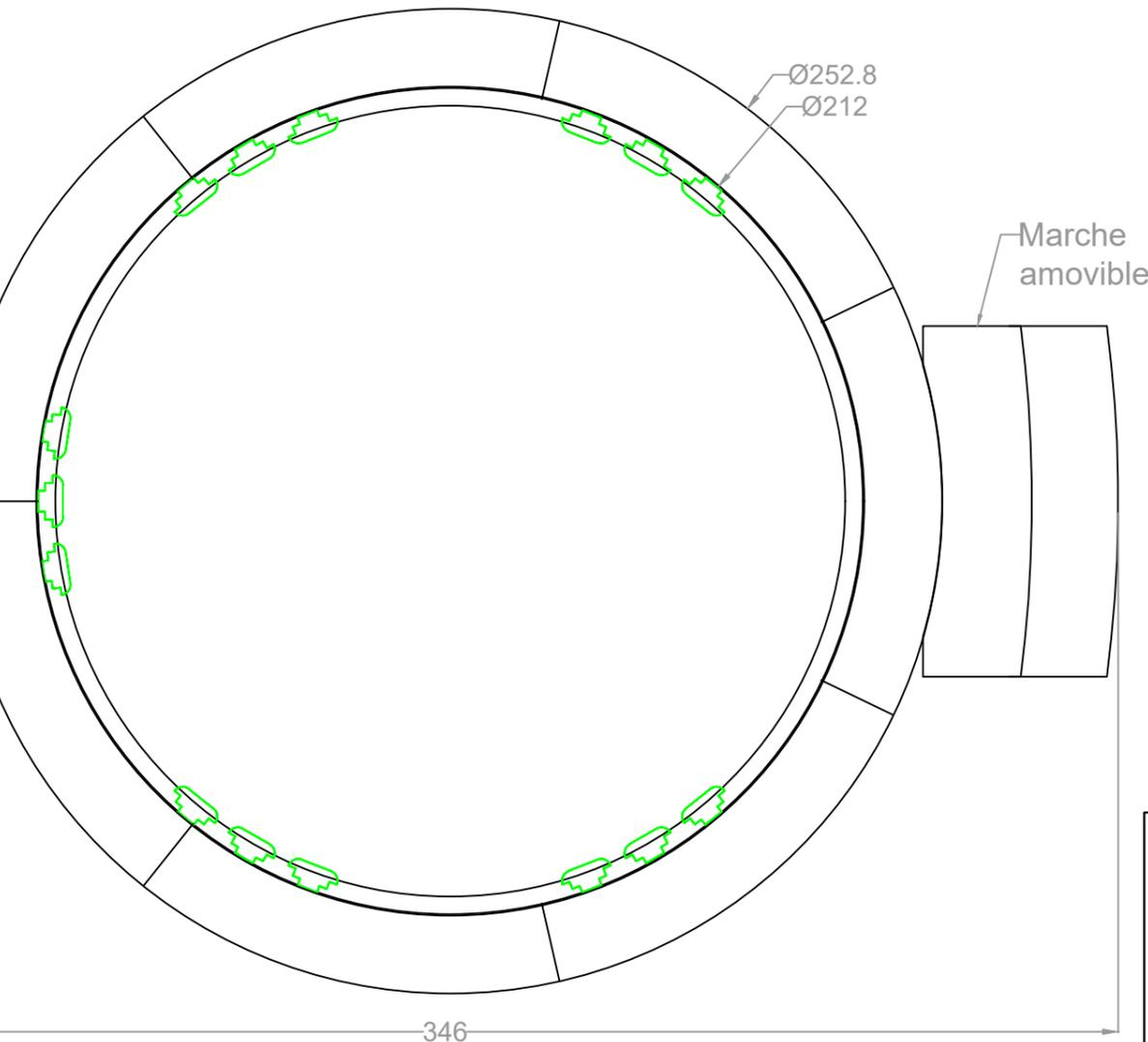
En cas de maçonnerie circulaire, veuillez à respecter les dimensions en rouge. le spa une fois posé cachera la maçonnerie.
